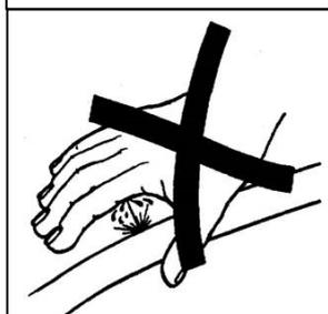
**ATTENTION AUX FUITES DE LIQUIDE SOUS PRESSION :** car celui-ci peut avoir suffisamment de force pour pénétrer sous la peau et pouvant causer de graves blessures. Eliminer la pression avant de débrancher tous flexibles hydraulique ou autre. Protéger les mains avant toute opération.
