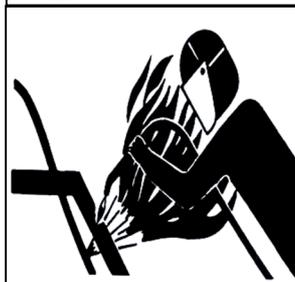
**EVITER TOUTE CHALEUR INTENSE PRES DE FLEXIBLES SOUS PRESSION :** car celle-ci peut provoquer des jets de vapeurs inflammable, pouvant entraîner de graves blessures. Ne pas souder ni utiliser de chalumeau à proximité de flexibles.
